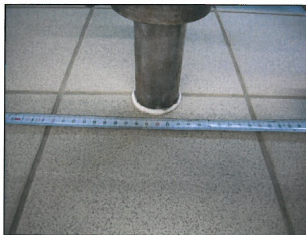
Bild 2: Stempel Ø 45 mm
