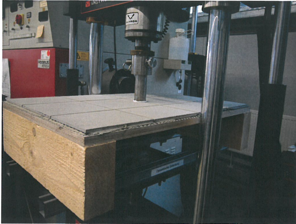
Bild 1: Dynamisches Prüfsystem mit Probekörper
